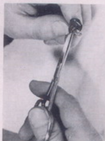
2. Haaks (= loodrecht) op de verkregen spleet wordt de buitenste plastic isolatiekous rondom weggeknipt.
