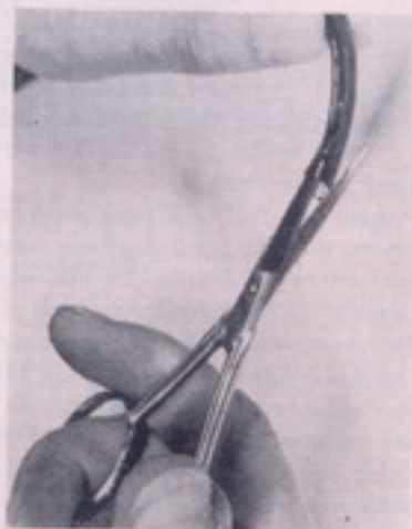
1. Steek de "puntigste" punt van een schaar voorzichtig onder de buitenste plastic isolatiekous (= D, zie boven) en knip die isolatie \pm 2 cm open.
